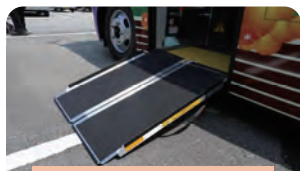
スロープ板を常備
