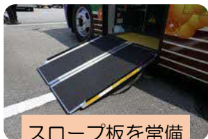
スロープ板を常備
