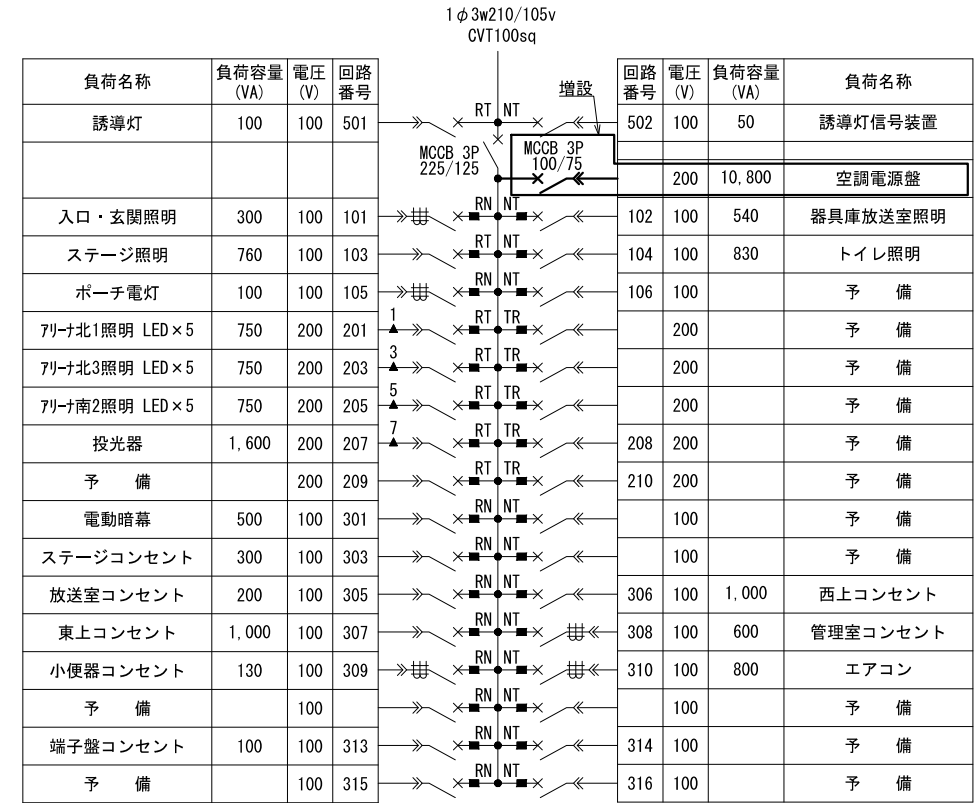
(現況：既設盤内改修)
